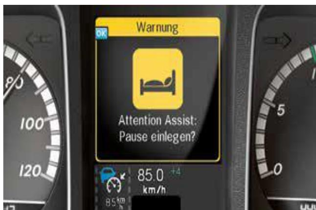
**Sistema di rilevazione stanchezza del conducente**
